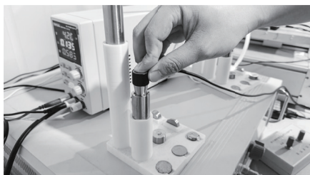
Рис.2 Надёжное прижатие зонда к поверхности измеряемого материала
