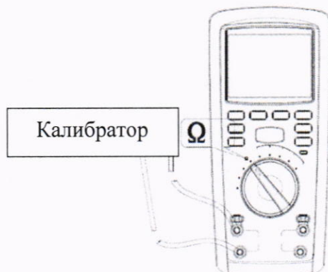
Рисунок 5 – Схема подключений для определения абсолютной основной погрешности измерений электрического сопротивления постоянному току для мегаомметров модификации RGK RT-30
