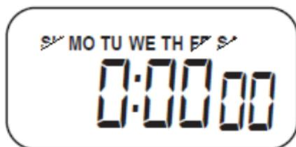
Если число секунд не равно нулю, нажмите кнопку (3), чтобы остановить отсчет времени. Затем нажмите кнопку (1), чтобы сбросить секундомер на ноль. Далее нажмите кнопку (3), чтобы начать отсчет времени, а для его остановки нажмите кнопку (3) еще раз. (При многократном нажатии кнопки (3) отсчет времени будет многократно запускаться и останавливаться). Нажмите кнопку (1), чтобы сбросить остановленный секундомер на ноль.
