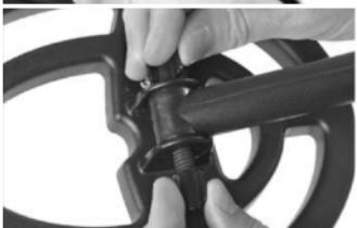
3. Вставьте болт с резьбой в отверстия нижней штанги и поисковой катушки. Вручную затяните болт барашковой гайкой.
