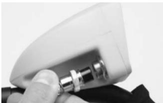
7. Вставьте кабель в соответствующий разъём пульта управления и затяните соединение вручную.
