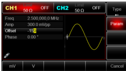
Рис. 9 Установка напряжения смещения
