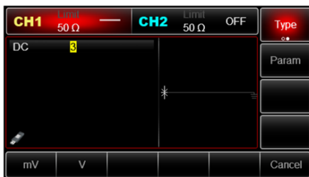
Рис. 13 Установка параметров сигнала постоянного тока
