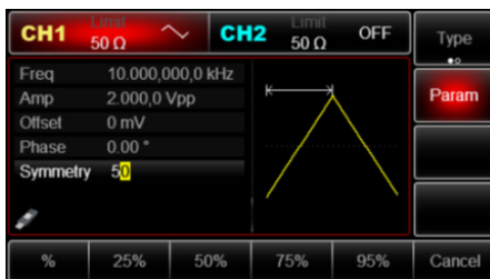
Рис. 14 Установка коэффициента симметрии пилообразного сигнала
