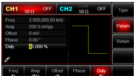
Рис. 73 Установка коэффициента заполнения несущего прямоугольного сигнала в режиме модуляции SUM
