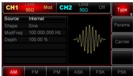
Рис. 22 Выбор источника модулирующего сигнала
