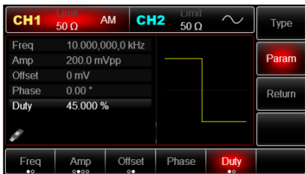
Рис. 25 Выбор параметров несущего сигнала
