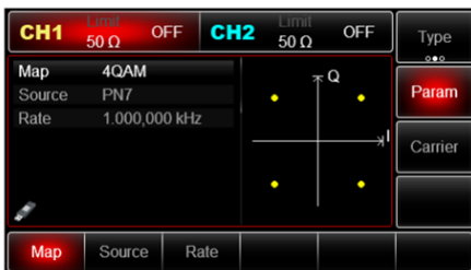
Рис. 84 Параметры квадратурной амплитудной модуляции
