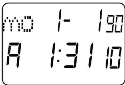
Нажмите кнопку (1), выбранный параметр начнёт мигать. Нажатие кнопки (2) увеличивает значение параметра на единицу. Вы можете настроить функции часов с помощью кнопок (1) и (2), последовательно переходя между параметрами: год > месяц > день > формат (24:00 или 12:00) > часы > минуты > секунды.
