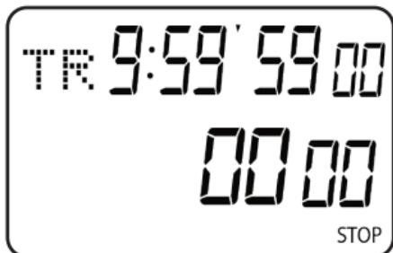
Нажмите кнопку (1), чтобы установить время отсчета в часах. Последовательным нажатием кнопки (2) выберете время отсчета таймера - от 0 до 9 часов. Повторно нажмите кнопку (1). С помощью кнопки (2) установите время отсчета таймера - от 0 до 59 минут. Удерживайте кнопку (2) для быстрого изменения значения минут. Повторите последовательность из кнопок (1) и (2) для установки времени отсчета таймера в секундах. Нажмите кнопку (1) для сохранения времени таймера.
