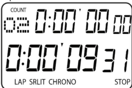
На секундомер RGK SWE-02 можно записать и вывести на экран до 10 отрезков. Для вывода на экран сохранённых данных нажмите кнопку (3). В первой строке отображается время каждого отрезка, а во второй строке – суммарное время всех отрезков.
