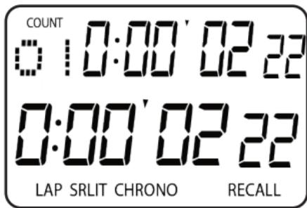
При каждом нажатии кнопки (3) на экране будут последовательно отображаться записанные в память отрезки времени. Данные выводятся на экран циклично.
