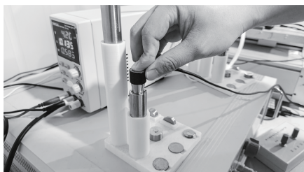
Рис.2 Надёжное прижатие зонда к поверхности измеряемого материала
