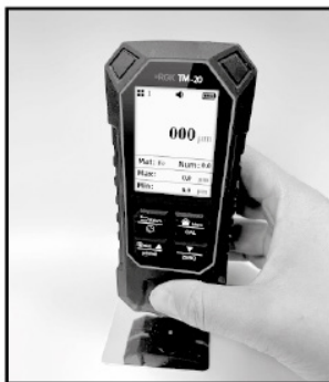
Рис. 1 Неправильное включение прибора
