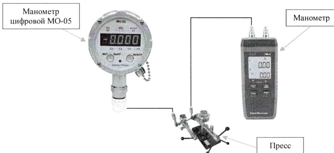
Рисунок 1 – Схема подключений при определении приведенной (к верхнему пределу диапазона измерений) погрешности измерений избыточного давления и приведенной (к верхнему пределу диапазона измерений) погрешности измерений дифференциального давления
