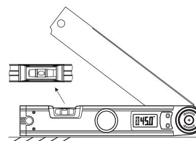
Установите неподвижную линейку на исследуемую поверхность. Если поверхность строго горизонтальна, пузыrek горизонтального уровня будет расположен между отметками на колбе.
