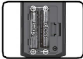
Откройте крышку батарейного отсека на задней панели устройства и установите батареи в соответствии с полярностью. Закройте крышку батарейного отсека.
